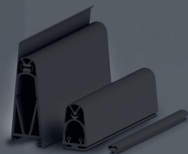
Die Sicherheitskontaktleisten **SENTIR edge** sind druckempfindliche Sensoren zur Schließkantensicherung, mit optimalen Nachlaufwegen und einem extrem schnellen Schaltverhalten. Das Plug'n'Sense-Selbstkonfektionssystem ermöglicht die Konfektion einer Schaltleiste ohne Werkzeug und ohne Verkleben innerhalb kürzester Zeit und unabhängig von Umgebungsbedingungen, z.B. im Service-Fall direkt am Tor. **Einfach. Sicher.** Einzigartig.
