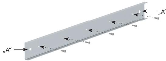
1. Zum Anbringen des Bumpers muss die Befestigungswanne mit Maschinenschrauben M6 montiert werden.
