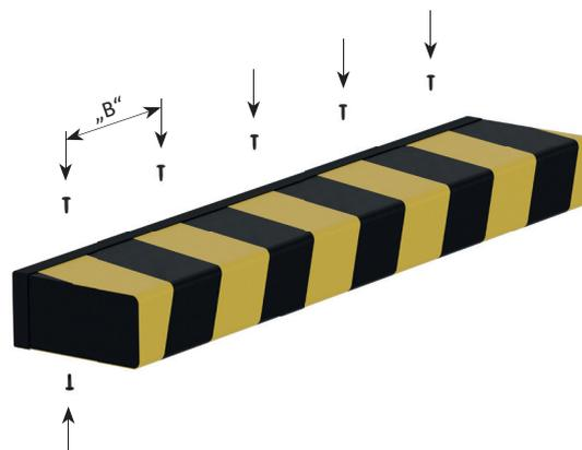
4. Wenn alles passend justiert ist, sind die mitgelieferten Schrauben, in gleichmäßigem Abstand „B“ (**nicht größer als 200 mm**), auf der Kunststoffschiene (Nut) einzuschrauben (maximales Anzugsdrehmoment 2Nm). Zuletzt muss geprüft werden ob alles fest verbunden ist.
