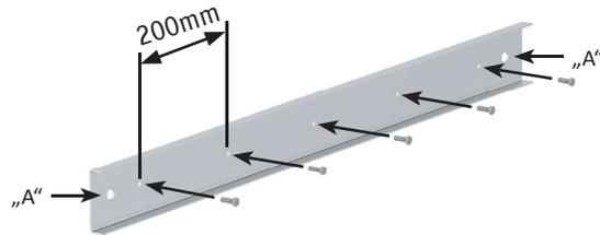
1. Zum Anbringen des Bumpers muss die Befestigungswanne mit Maschinenschrauben M6 mit 200mm Abstand zueinander montiert werden.
